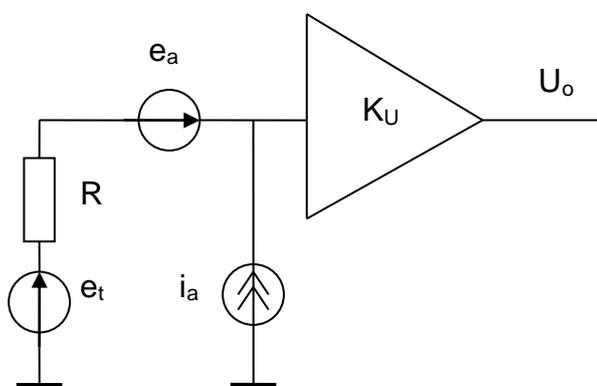
Рис. 1. Эквивалентная схема генератора шума
